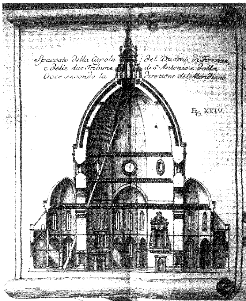
Sezione del Duomo di Firenze lungo il meridiano con rappresentazione del momento solstiziale (da L. XIMENES, Del vecchio e nuovo gnomone fiorentino e delle osservazioni astronomiche, fisiche ed architettoniche fatte nel verificarne la costruzione libri 4 , Firenze 1757).
